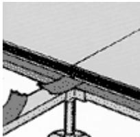
Non danneggiare la guarnizione in gomma sulle traverse dei pavimenti dotati di struttura durante la rimozione dei pannelli; potrebbe essere compromessa la tenuta ermetica del sottopavimento.
