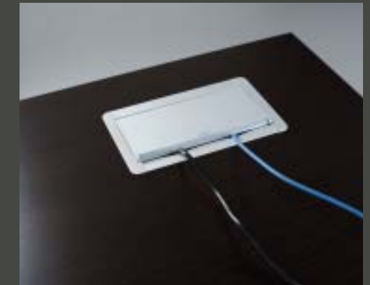
Scrivania: top access in alluminio con sportello apribile e sistema a cerniera con apertura "push" a spinta. Il gruppo prese è integrato allo sportello e, quando viene chiuso, permette il passaggio e il blocco dei cavi grazie alla guarnizione morbida. Desk: aluminum top access with opening "push" system. The socket system is integrated to the opening to permit the passing of the cables when it is closed.
