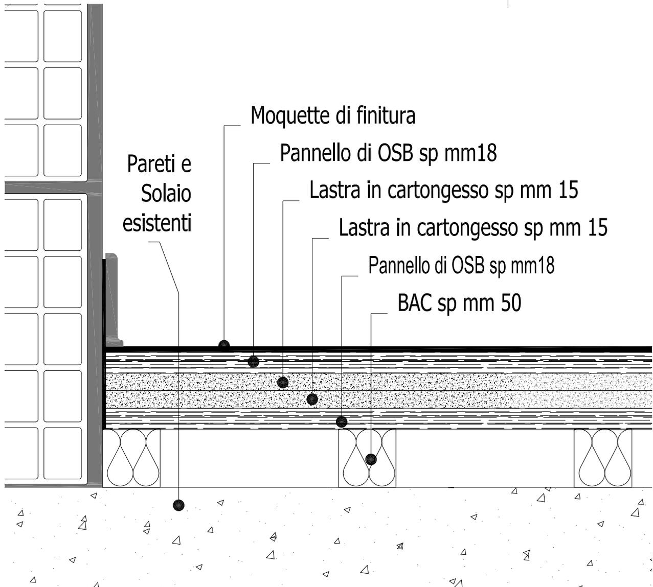
**Pavimento fonoisolante a secco, supporti distanziatori in lana di roccia ad alta densità, su cui vengono posati, sfalsati, due strati di OSB sp mm 18 e due di cartongesso sp mm 15, nella sequenza indicata in sezione.
