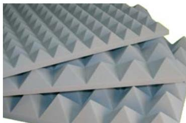
Pannello in resina melamminica, indicato in particolare per rivestimenti fonoassorbenti di locali e macchinari; idoneo per l'impiego a vista. Da porre in opera mediante incollaggio o fissaggio meccanico. E' compatibile con tutte le colle a base di acqua e con la maggior parte di quelle a base di solvente. Il materiale è idoneo a essere verniciato, con l'avvertenza che un eccessivo spessore sulla superficie a vista ne può variare le caratteristiche di assorbimento acustico alle varie frequenze.
