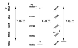
$\begin{array}{ll} n &= \text{numero di elementi in legno per metro} \\ t &= \text{spessore di ciascun elemento in legno, in metri} \\ w &= \text{larghezza di ciascun elemento in legno, in metri} \\ a &= \text{superficie esposta della struttura di supporto in legno (eventuale), in m², per m² dell'elemento nastro di legno} \end{array}$
